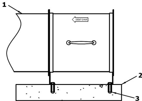
Figure 3. Ventilateur monté sur dalle (ventilateur centrifuge)
